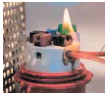
Labortechnische Untersuchung; Glühdrahtprüfung an einer CEE-Steckvorrichtung zur Bestimmung der Temperaturbeständigkeit der Isolierstoffe. Bei reduzierter Flammhöhe wurde die Prüfung bestanden.
